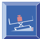
Teste de estabilidade a 180 kg
